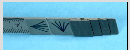
Abb. 1c: Rechtes Ende: 4 Metallplättchen von 0,5mm bis 2,0 mm Dicke; Messung: Diastema, frontale Engstände, Lücken Mitte: 2 Winkelmesser in 15°-Schritten; Messung von Zahnrotationen und Kippungen nach Björk (1964)
